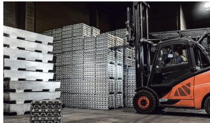
So sehen Zinkbarren aus, bevor sie weiterverarbeitet werden – beispielsweise zu Zinkblechen oder zu korrosionsgeschützten Stahlkonstruktionen, die mit ihrer langen Lebensdauer im Baubereich eingesetzt werden. Wegen der hohen Recyclingquote und der extrem langen Lebensdauer gilt der Werkstoff Zink als besonders ökologisch.
