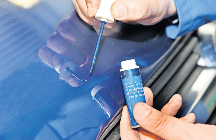
Kleine Steinschläge im Lack lassen sich per Smart-Repair unsichtbar machen. Foto: djd/Kfzgewerbe
